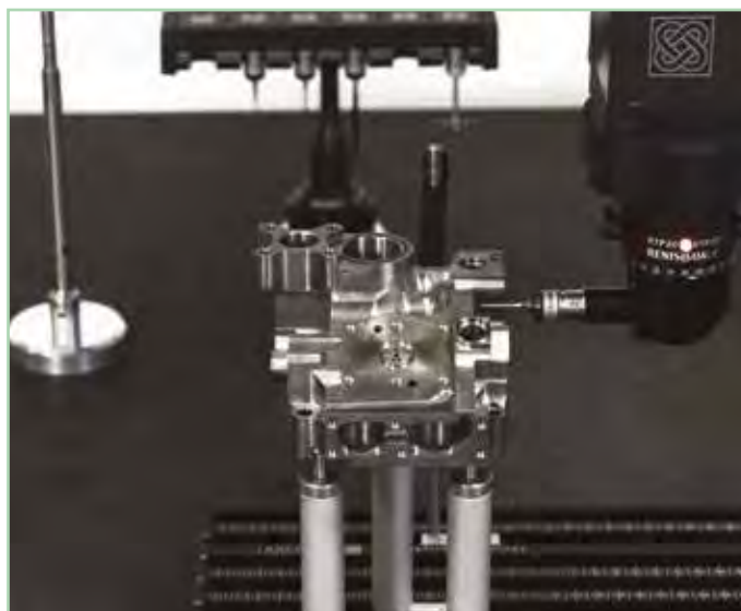
Tastatore Renishaw RTP20 orientabile e indexabile automaticamente (opzionale). RTP20 Renishaw sensor automatically indexable (optional).
